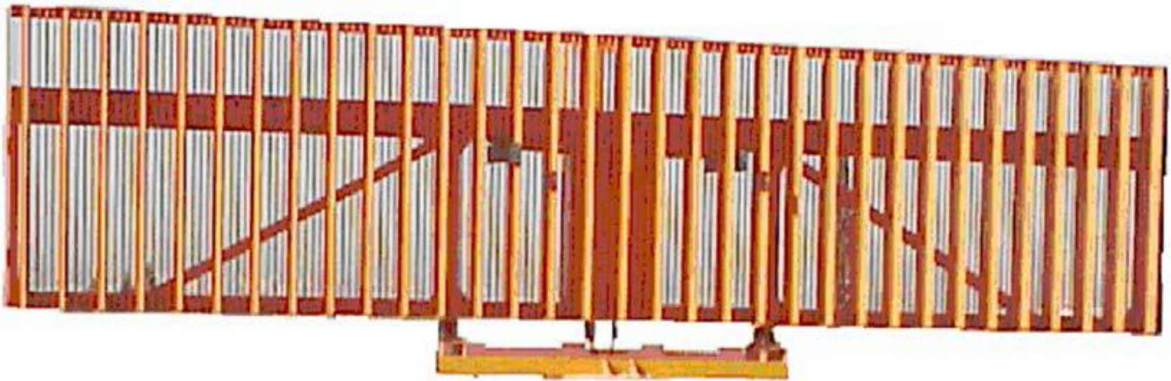
Antena de apertura sintética que utiliza el radar monopulso IRS-20
